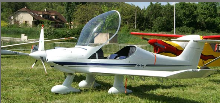
Le MCR de JB Duchatelle équipé des trois roues et des freins aux palonniers en place pilote et passager, avec régulateur anti-blocage et frein de parking
