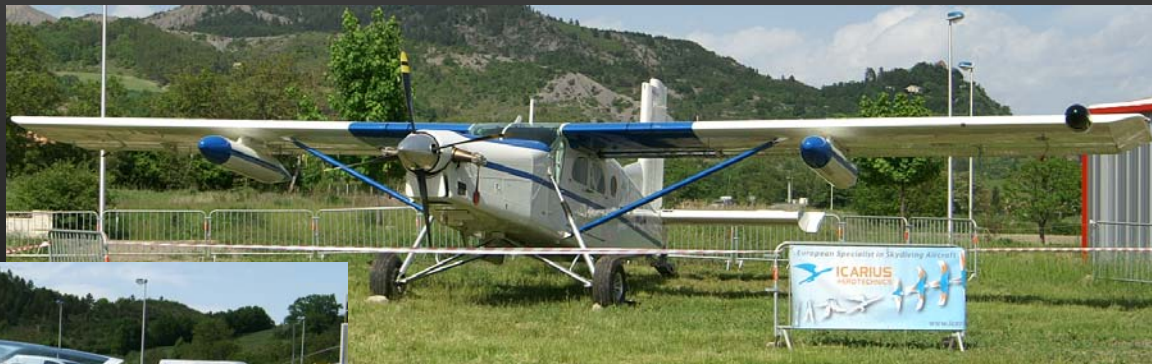
Pilatus PC-6 d'Icarius, équipé du kit complet 3 roues et freins BERINGER
